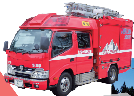
水槽付消防ポンプ自動車 (魚沼北ポンプ1号車) (水槽600ℓ CABS装置搭載)
