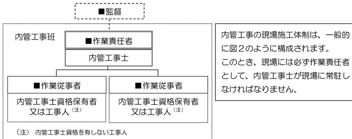
図2 内管工事の現場施工体制（例）
