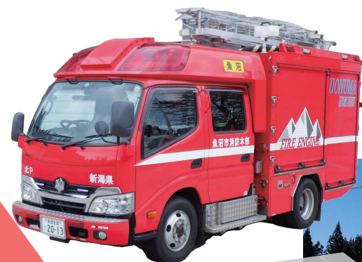
水槽付消防ポンプ自動車 (魚沼北ポンプ1号車) (水槽600ℓ CAFS装置搭載)
