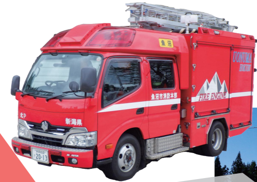
水槽付消防ポンプ自動車 (魚沼北ポンプ1号車) (水槽600ℓ CAFS装置搭載)
