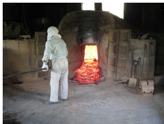
白炭製造工程（炭出し作業）
