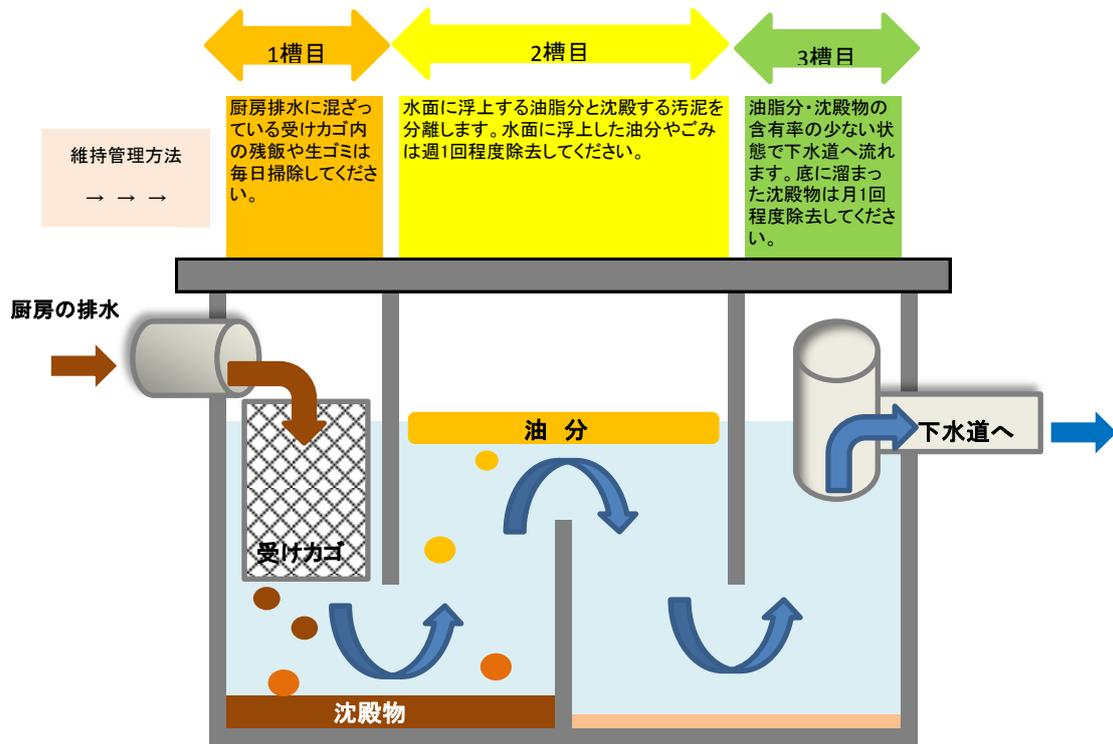
※グリーストラップとは排水中の油脂分の阻集器であり、油脂分を分解・処理するものではありません。排水を仕切り版で仕切られた槽内を通すことにより滞留時間を取り、排水中の油脂分を浮上・分離し阻集するものです。分離した油脂類を取り除かなければ、そのまま排水管へ流れ詰まりの原因となります。
