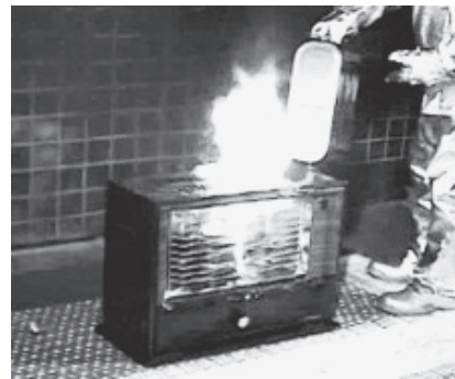
▲カートリッジの蓋が外れて灯油がかかり、炎が上がる様子
