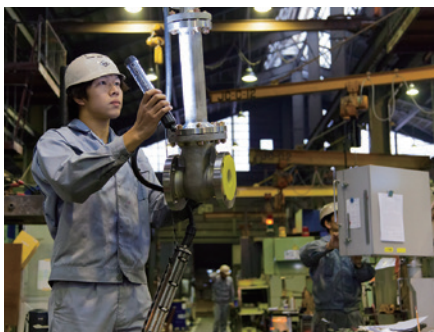
バルブ外観検査
