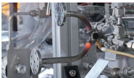
燃焼終了直後の赤熱した分岐管
